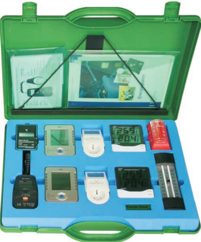
Con los dos termómetros análogos se puede medir la temperatura ambiental y sus valores mínimos y máximos.
